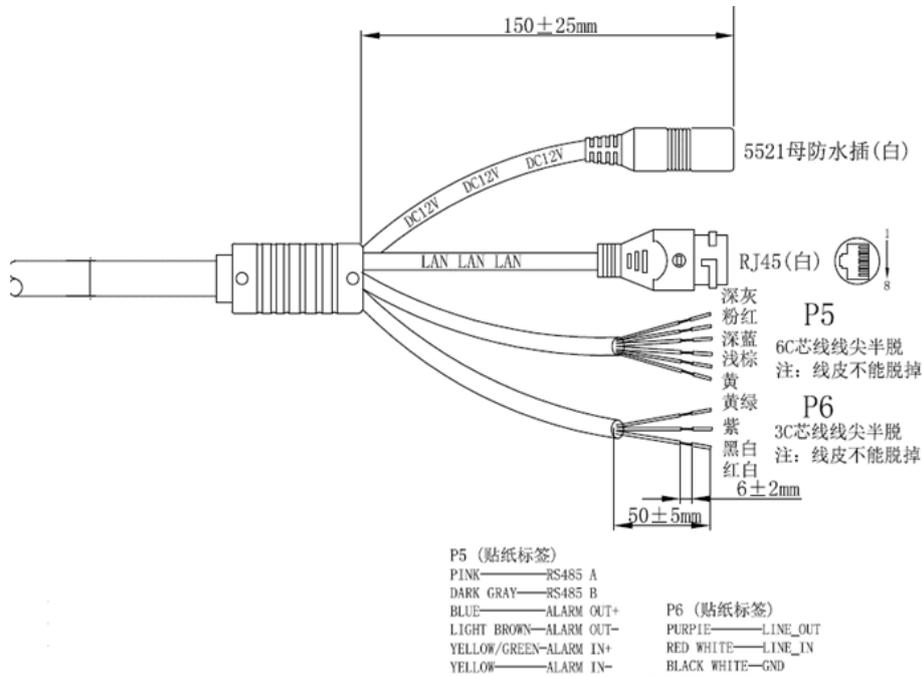
图 2-2 RF 一体机 NPN 型尾线接口
